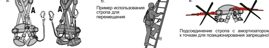
Рис. 6. Использование карабинов, входящих в комплектацию стропов
