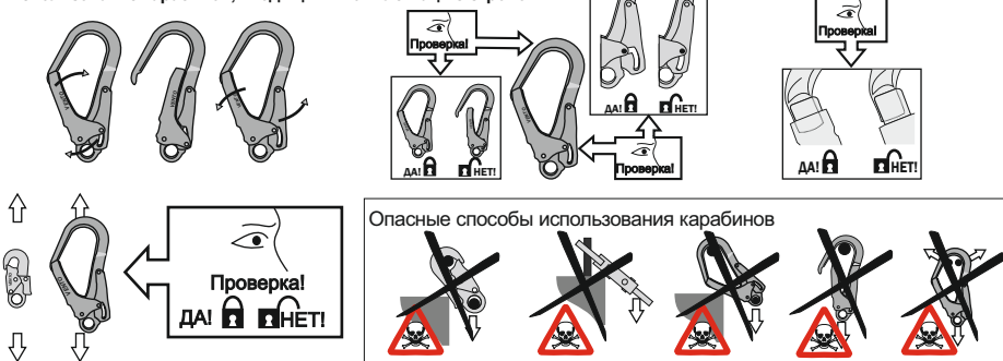
Рис. 6. Использование карабинов, входящих в комплектацию стропов
