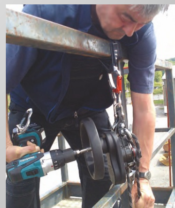
Anheben des Verletzten mit Akkuschrauber
