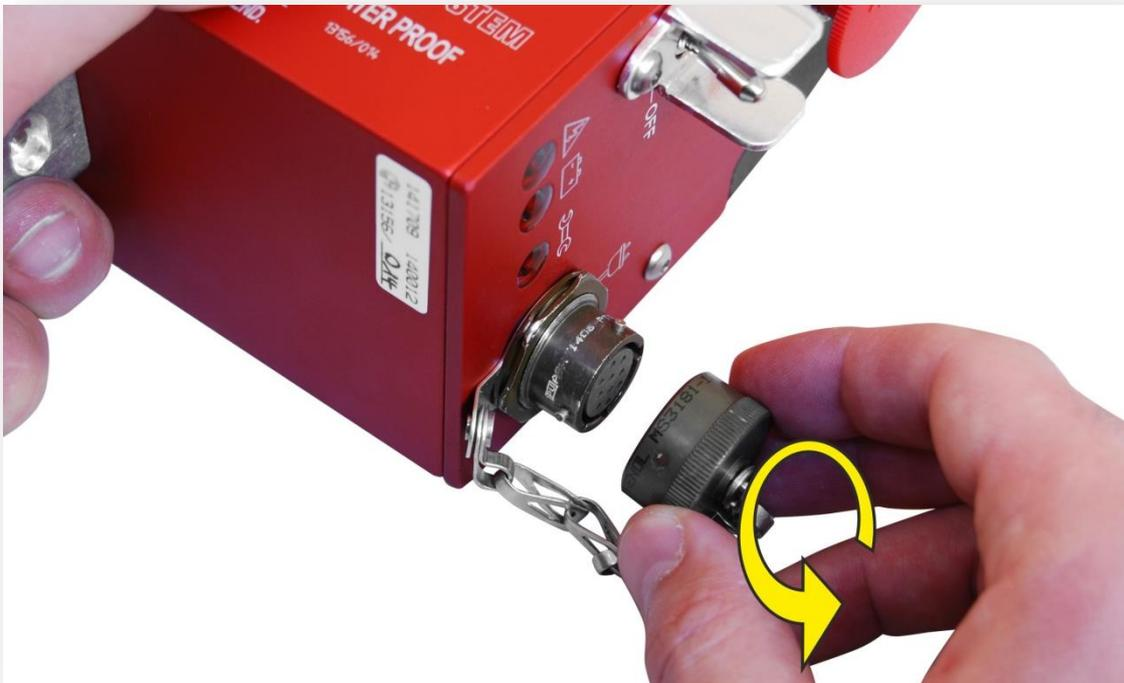
FIG.20 Apertura connettore carica batteria
