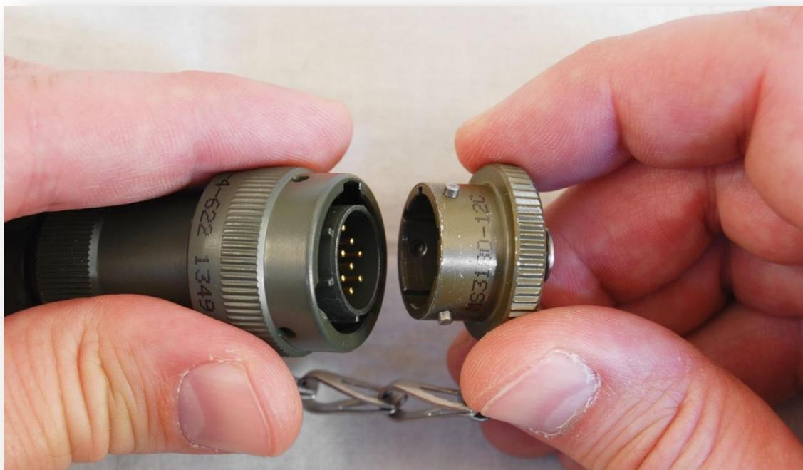
FIG.21 Connettore carica batteria
