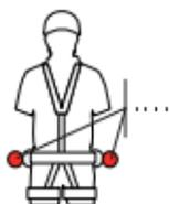
Boční úchytné body - Fastspændingspunkter i siderne - seitliche Halteösen - Σημεία πλευρικής σύνδεσης - Lateral attachment points - Puntos de enganche laterales - Sivukiinnityskohdat - Points d'attache latéraux - Punti di attacco laterali - Bevestigingspunten zijkanten - Ponto de fixação lateral - Sidoförankringspunkter
