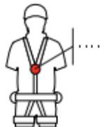
Hrudní úchytný bod - Fastspændingspunkt på brystet - Brustöse - Σημείο στερνικής σύνδεσης - Sternal attachment point - Punto de enganhe esternal - Rintakiinnityskohta - Point d'attache sternal - Punto di attacco sternale - Bevestigingspunt borstzijde - Ponto de fixação peitoral - Bröstförankringspunkt
