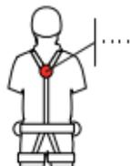
Hřbetní úchytný bod - Fastspændingspunkt på ryggen - Rückenöse - Σημείο ραχιαίας σύνδεσης - Dorsal attachment point - Punto de enganhe dorsal - Selkäkiinnityskohta - Point d'attache dorsal - Punto di attacco dorsale - Bevestigingspunt rugzijde - Ponto de fixação dorsal - Ryggförankringspunkt
