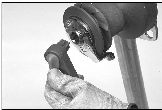
Dopo aver verificato il corretto posizionamento e la stabilità del cavalletto, inserire le manovelle nel winch, facendo ruotare la levetta in testa al manico per fare combaciare il quadro di sicura, (fig. 12) per toglierle eseguire la manovra inversa.
