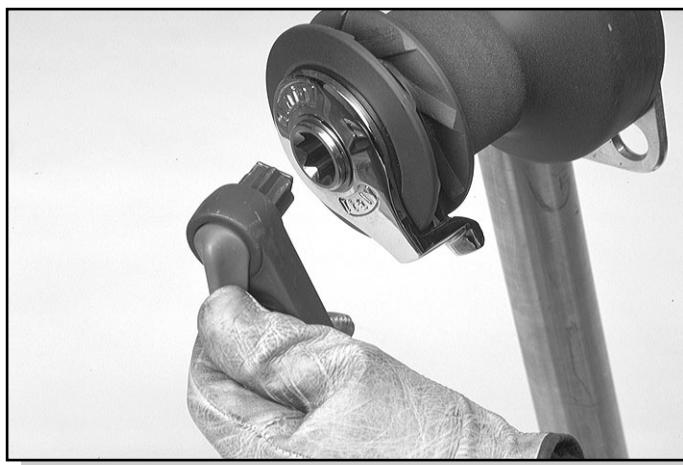
Nach der Überprüfung der Positionierung und Festigkeit des Rettungsbocks stecken Sie die Kurbeln in die Winde durch die Drehung des kleinen Hebels oben am Handgriff, um den Sicherungsvierkant zu stoßen (Abb. 12). Um die Kurbeln herauszunehmen, verfahren Sie umgekehrt.
