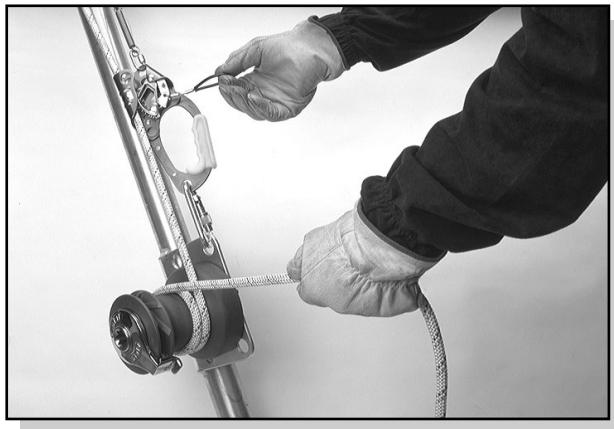
La manovra di calata avviene facendo slittare la corda sul tamburo: la regolazione della velocità di calata avviene mediante l'avvolgimento di più o meno giri della corda sul tamburo e una maggiore o minore tensione sulla corda (fig.18). Si consiglia l'uso dei guanti.
