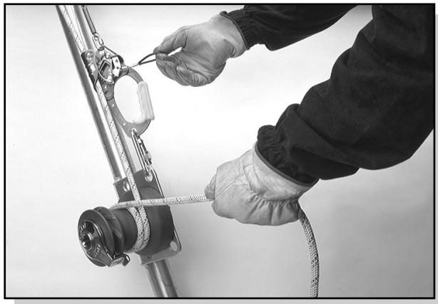
**ATTENTION:** N'ouvrez pas le cliquet du bloquant en débloquant complètement le levier de sûreté (FIG. 15) et n'introduisez pas le doigt dans la boutonnière du petit câble (FIG. 16).
