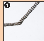
Knick in Stahlseil
