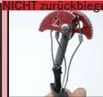
Verformung tragender Achsen
