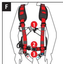
Auffanggurt auf die persönlichen Maße (mit entsprechender Kleidung) einstellen. Sitz des Auffanggurtes prüfen. Schultergurte und Beinschlaufen sollten am Körper anliegen, aber nicht einengen. Die Schultergurtbänder müssen gleich lang eingestellt sein. Die rückseitige Auffangöse muss mittig zwischen Schulterblättern liegen.
