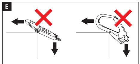
**F** Rohr-/Gerüsthaken nicht über Schließblech/Schnapper belasten.
